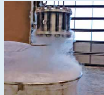
Tiefemperaturanwendung Cryogenic Leakage Test
