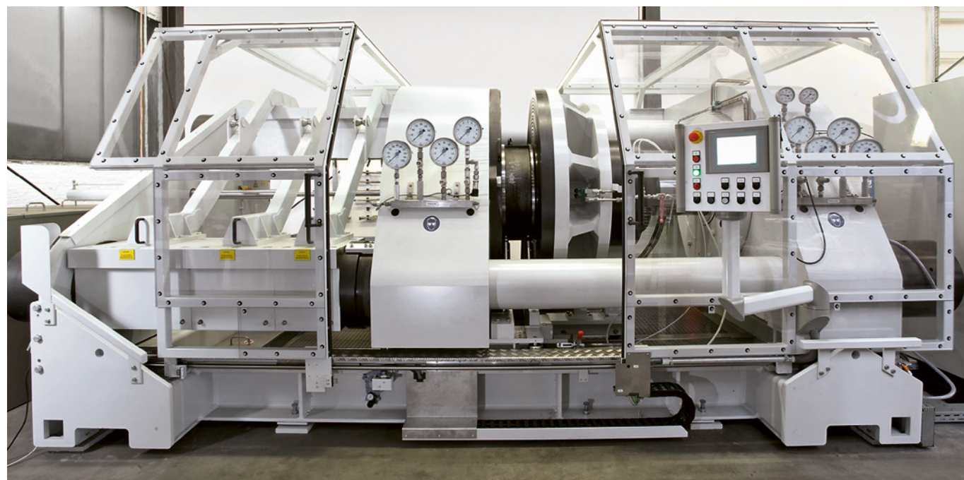
■ RITAG DN 1400 / 56" Prüfstand RITAG DN 1400 / 56" Test Facility
